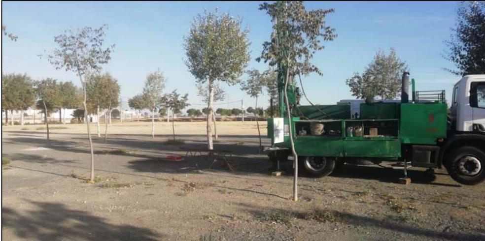
Durante la perforación del sondeo se han realizado ensayos estándar de penetración SPT y toma de Muestras Inalteradas, cuyos valores, resultados de  $N_{30}$ , nos permiten conocer la compacidad y homogeneidad de las capas prospectadas.
