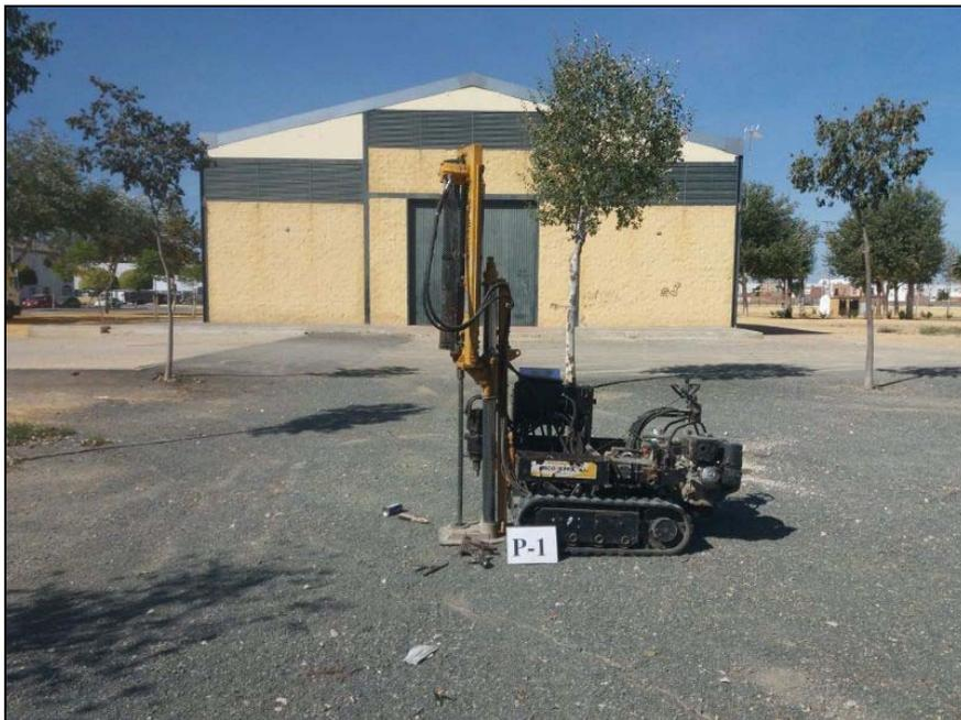
En el Anejo nº 4 se adjuntan las diagráfias profundidad/ $N_{20}$  obtenidos de los ensayos penetrométricos realizados. Estos diagramas reflejan una medida indirecta, y casi continua, de la resistencia y de la deformabilidad de los distintos estratos atravesados.
